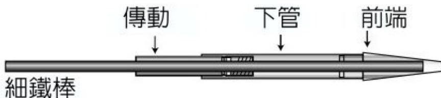
2. 退出傳動: 固定管立放在桌上, 傳動插在固定管中, 粗鐵棒穿入後用鐵槌敲擊棒尾, 慢慢將傳動鬆動退出下管。
