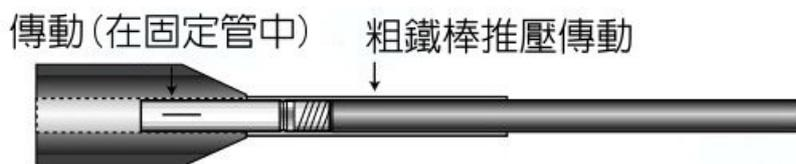
3. 退出後塞: 以手握緊上管, 粗鐵棒穿入後用鐵槌敲擊棒尾, 慢慢將後塞鬆動退出上管。
